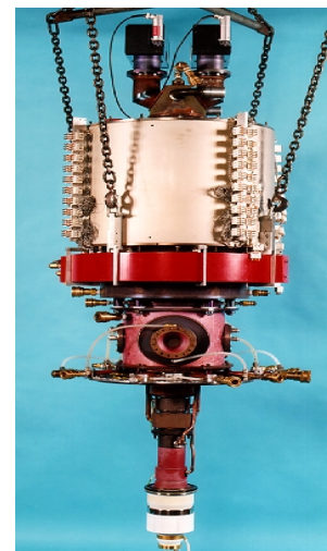
Fig. 2.28. Prototype 1-MW gyrotron.
