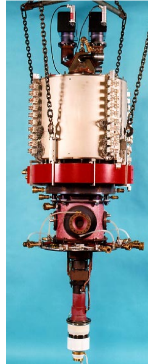
Fig. 2.22. Prototype 1-MW gyrotron.
