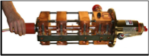
~$5/watt L3 13 kw Klystron
